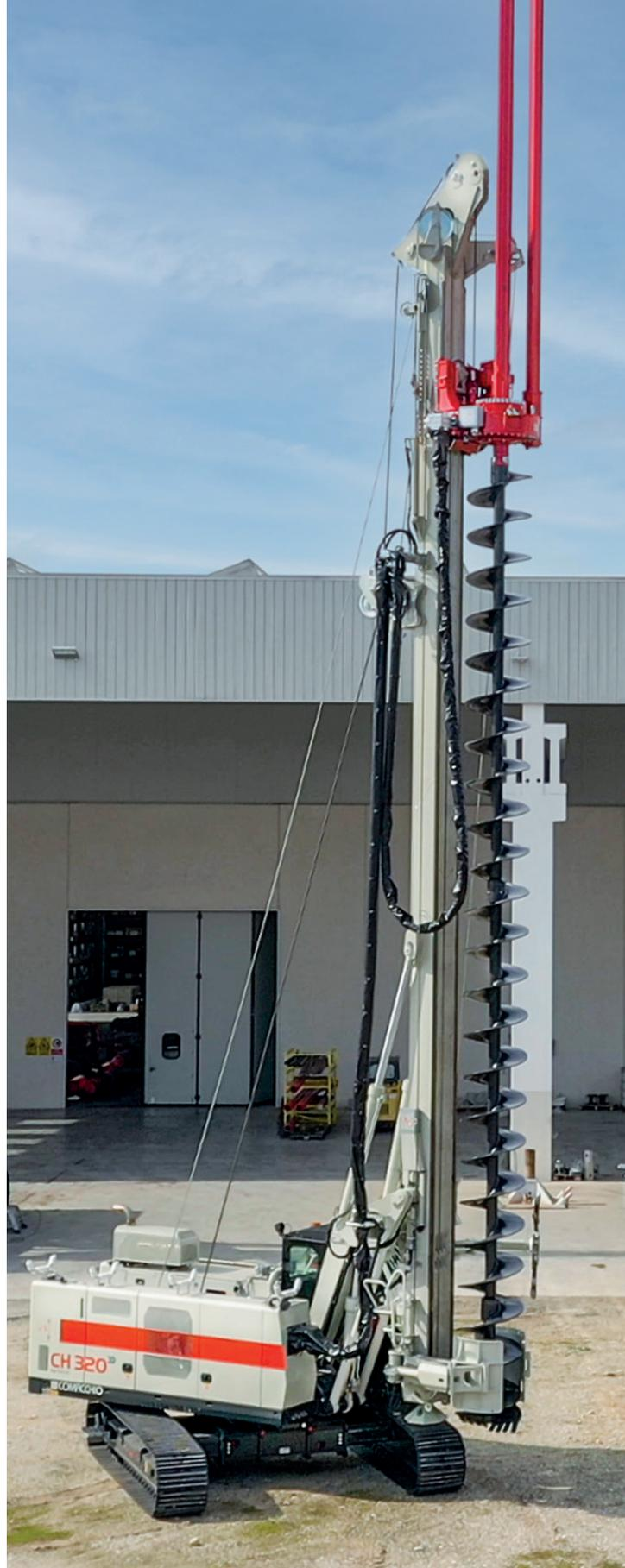
**La CH 320 ha un peso di trasporto inferiore alle 32 t con rotary e asta kelly installate, una massa che può essere ulteriormente ridotta (sotto le 30 t) togliendo il kelly.**
