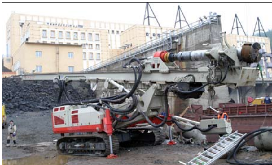
The Comacchio drill rig MC 3000 with DTH hammer / Буровая установка Comacchio MC 3000 с пневмударником
