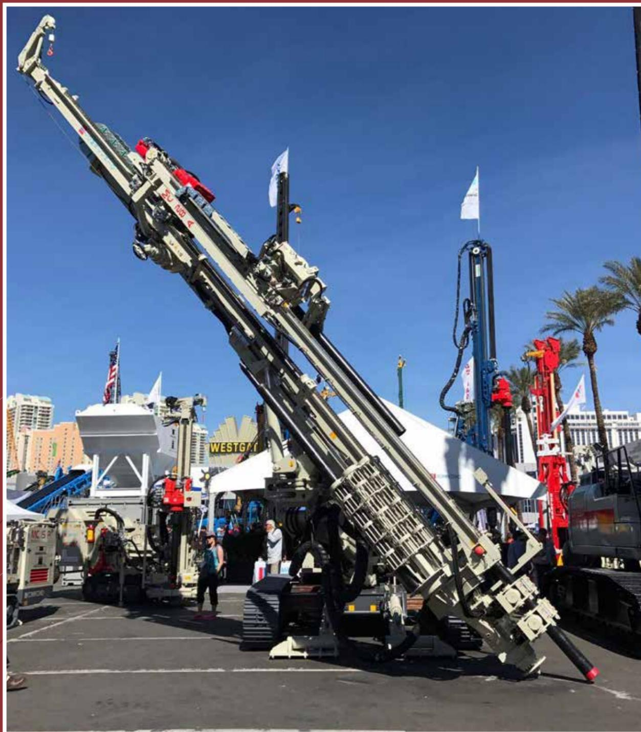
un massimo di 114 mm per le aste e 178 mm per i rivestimenti), fino a 3,5 m di lunghezza, raggiungendo una lunghezza massima della batteria di perforazione pari a 30 m. Il design heavy duty include un sottocarro maggiorato con larghezza variabile (2500-3400 mm) che garantisce elevata stabilità. La MC 28 A HD può raggiungere 9.500 mm di corsa del mast, consentendo co-
