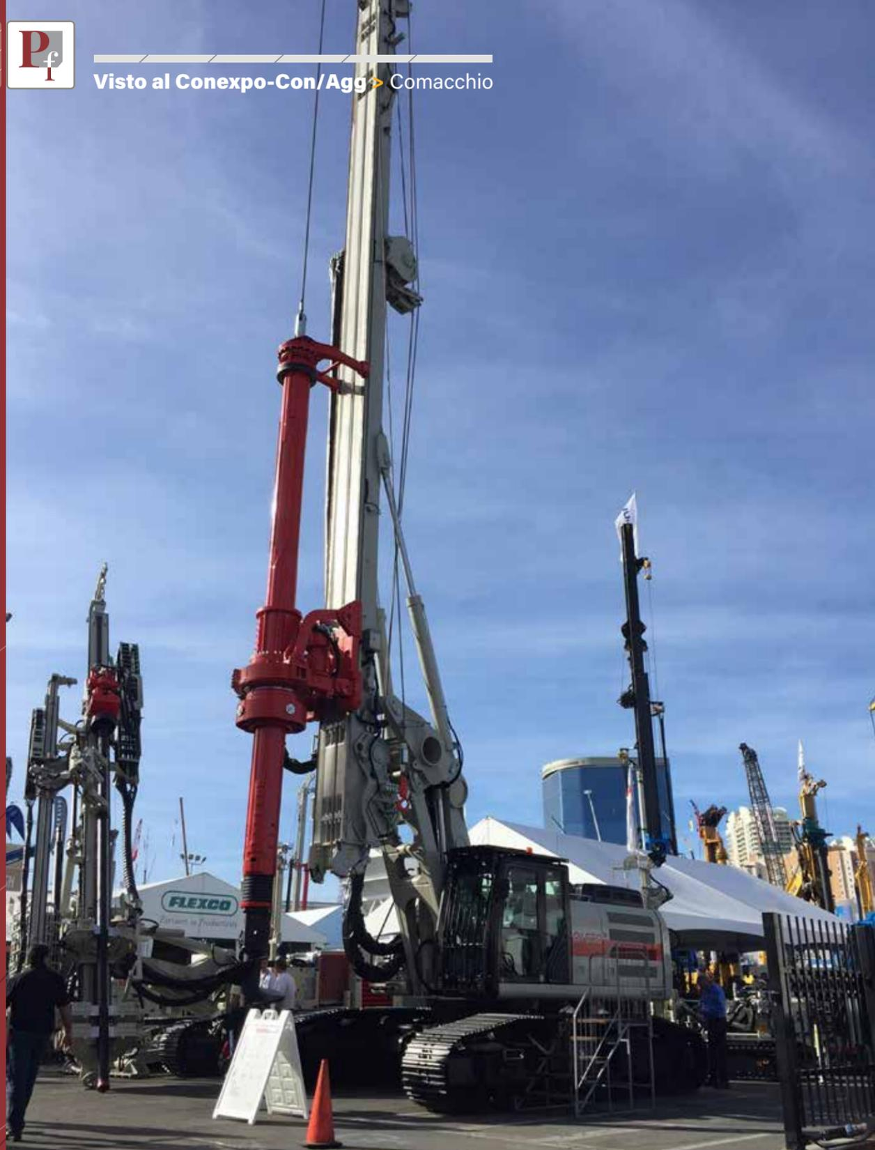
L'innovativo sistema di canotto adottato da Comacchio consente l'utilizzo di aste Kelly di diverso diametro, comprese aste HD (heavy duty) e XHD (extra heavy duty), con piccole modifiche sulla testa di rotazione. La testa di rotazione offre 262 kNm di coppia
